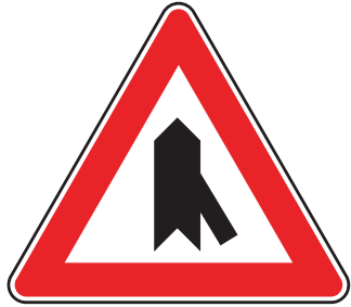
إلتقاء مع طريق سريع من جهة اليمين Road merging to the right
